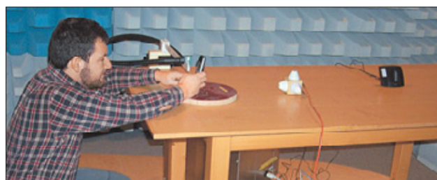
Ingenieur Raimund Blask testet, wie gut die Prüflinge gegen Funkstrahlen von Handys und anderen DECT-Telefonen geschützt sind.
