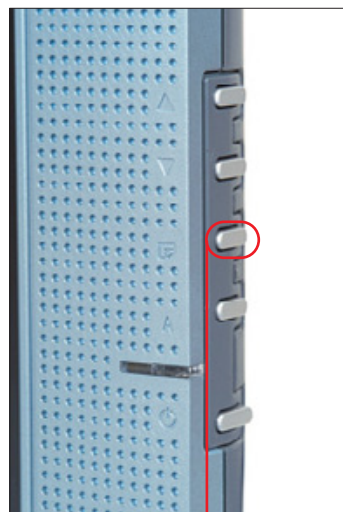
Sie müssen die Taste am „965 TFT“ drücken, um zum Bildschirmenü zu gelangen. Dann erst lassen sich Kontrast und Helligkeit einstellen.
