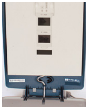
Beim HP-Scanner ist die Halterung für Dias und Negative auf der Deckelunterseite eingebaut.
