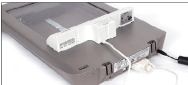
Mit diesem Durchlicht-Aufsatz kann der Microtek-Scanner auch Dias und Foto-Negative einlesen.
